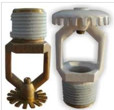
**Назначение:** оросители дренчерные водяные и пенные SP и SU предназначены для локализации или тушения пожара с помощью разбрызгивания воды и распределения ее по защищаемой площади, а также для создания водяных завес в автоматических установках пожаротушения с помощью воды, пены низкой кратности из водного раствора пенообразователя общего назначения типа ПО-6ТС марки А(Б) (концентрация 6%).
