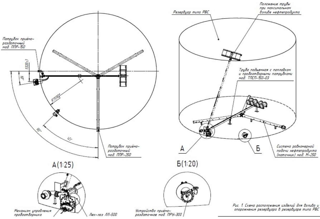
**Назначение:** система равномерной подачи М-250 (далее по тексту система М-250) предназначена для подачи нефтяной эмульсии в резервуар типа РВС и обеспечения равномерного растекания ее по всей площади дна резервуара.
