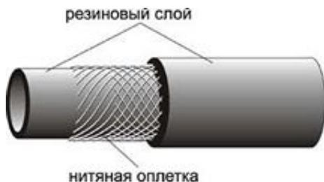
**Назначение:** рукава маслобензостойкие (МБС) (ГОСТ 10362-76) — применяются для подачи бензина, авиационного топлива, реактивного и дизельного масла на нефтяной основе, жидкостных смазок, охлаждающих жидкостей, слабых растворов кислот, воздуха и газов при температурах от  $-60^{\circ}\text{C}$  до  $+120^{\circ}\text{C}$ .
