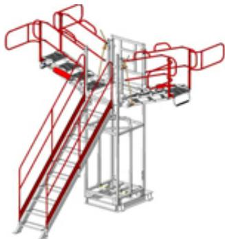
**Назначение:** площадки обслуживания ПО предназначены для безопасного перехода на цистерны и удобства проведения налива или слива нефти и нефтепродуктов, а также для других операций на объектах нефтепродуктообеспечения.
