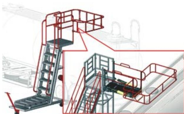
**Назначение:** лестницы передвижные для безопасного обслуживания автоцистерн предназначены для удобства работы обслуживающего персонала при осмотре и обслуживании автомобильных цистерн.
