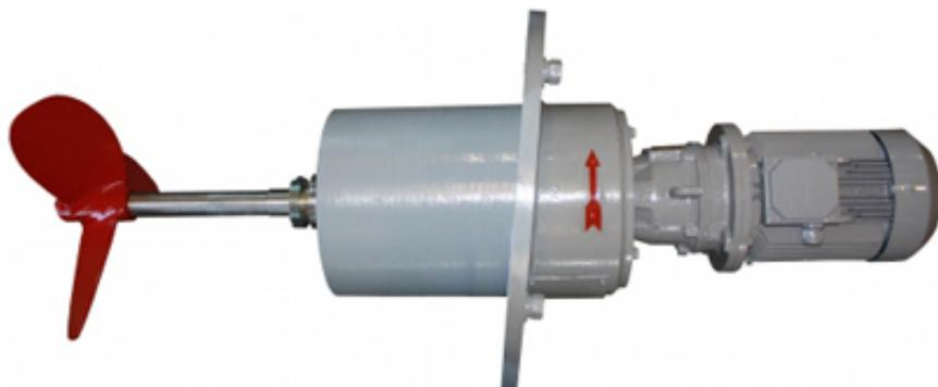
**Назначение:** неповоротные мешалки Серии -НМ с фиксированным углом отклонения выходного вала  $10^\circ$  и электродвигателями 5,5; 7,5; 11 кВт, одинарным торцовым уплотнением предназначены для перемешивания таких продуктов, как растительные масла, водные растворы, эмульсии и пр. в резервуарах объемом до  $3000 \text{ м}^3$  с целью усреднения их характеристик или предотвращения донных отложений.
