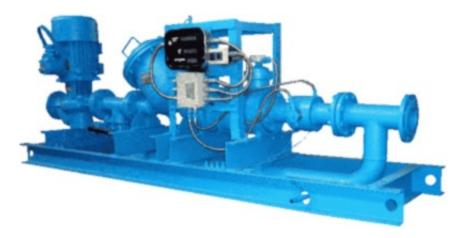
**Назначение:** комплексы измерительные типа УПН-100 предназначены для перекачивания и учёта нефтепродуктов на нефтебазах, в технологических нефте-трубопроводах и других объектах, где по условиям эксплуатации возможно применение данных установок.
