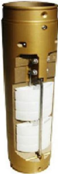
**Назначение:** клапан отсечной поплавковый двухступенчатый КО 2-80 ПС предназначен для снижения скорости потока топлива во время осуществления операции слива из автоцистерны в резервуар АЗС при достижении уровнем топлива 90 % объема резервуара и прекращения подачи топлива при наполнении резервуара до 95% его объема.
