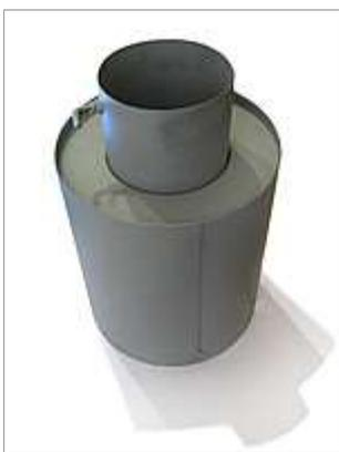
**Назначение:** искрогаситель автомобильный ИГС предназначен для установки на выхлопные трубы автомобилей, тракторов, комбайнов, въезжающих на территорию района высокой пожароопасности (нефтебазы, АЗС, сельхозугодия, территория нефтеперерабатывающих заводов, районы добычи нефти и газа) и обеспечивает улавливание и тушение искр в продуктах горения двигателей внутреннего сгорания.
