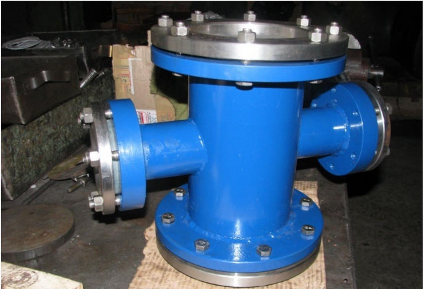
Фонарь смотровой трубопроводный — предназначен для визуального контроля наличия или отсутствия потока рабочей среды в трубопроводе. При этом возможность получения качественных или других характеристик рабочей среды — отсутствует.
