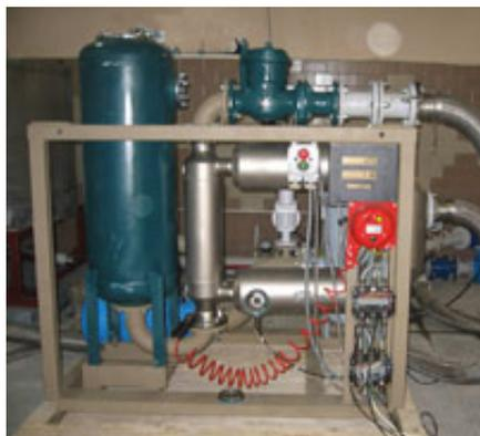
**Назначение:** автоматизированные измерительные установки предназначены для коммерческого учета и отпуска нефтепродуктов в единицах массы и объема. Установки могут эксплуатироваться на пунктах «слива-налива» на нефтебазах, нефтеперерабатывающих заводах и АЗС, а также для осуществления оптовой торговли нефтепродуктами в составе мини терминалов или в составе наливных эстакад.
