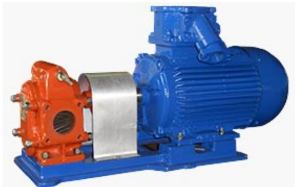
**Назначение:** агрегат электронасосный НМШ-32, НМШ-80 предназначены для перекачивания нефтепродуктов без абразивных примесей с кинематической вязкостью 0,2-20 см<sup>2</sup>/с (0,2-20 сСт) и температурой до +70°С.
